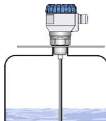
Obr. 7: Instalace hladinoměru v nekovové nádrži
